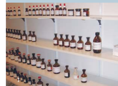
Billede 1 og 2 viser opbevaring af kemikalier i arbejdshøjde. Billede 2 er fra kemikaliesskab og billede 1 er fra laboratorium, hvor der opbevares mindre mængde på reol.
